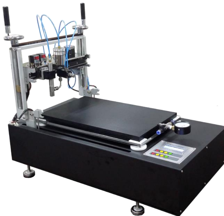
Figura 15 – Mesa de deposição automática via spray da Hantech Co.,Ltd. utilizada no trabalho de Lee, J. Y. et al. (2016). Imagem de http://www.hantech.biz/
