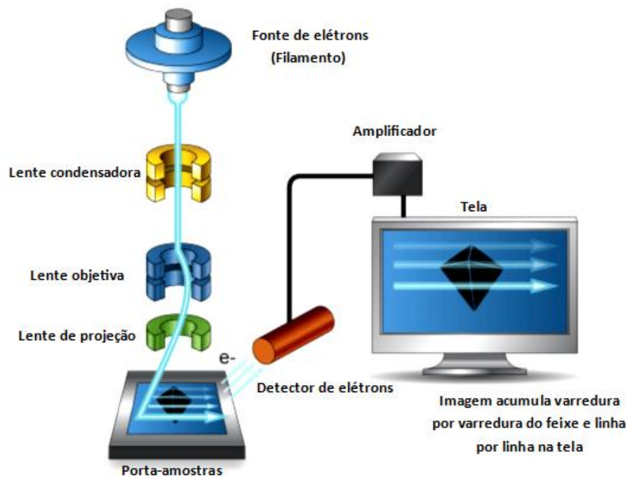
Figura 3.7- Esquema básico do microscópio Eletrônica de Varredura.
