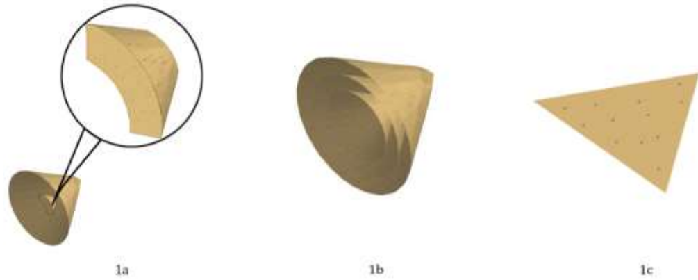
Figura 4.3 – Deformação Splay. Quando os vetores diretores são tangentes à superfície de um cone, a curvatura é nula, pois o cone é isômero ao plano. Entretanto, a energia elástica livre f não é nula devido ao termo splay, não nulo.
