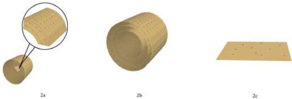
Figura 4.4 – Deformação Bend. Quando os vetores diretores são tangentes à superfície de um cilindro, a curvatura é nula, pois o cilindro é isômero ao plano. Entretanto, a energia elástica livre f não é nula devido ao termo bend, não nulo.
