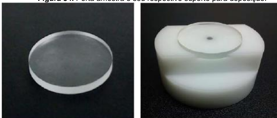
Figura 34. Porta amostra e seu respectivo suporte para deposição.
