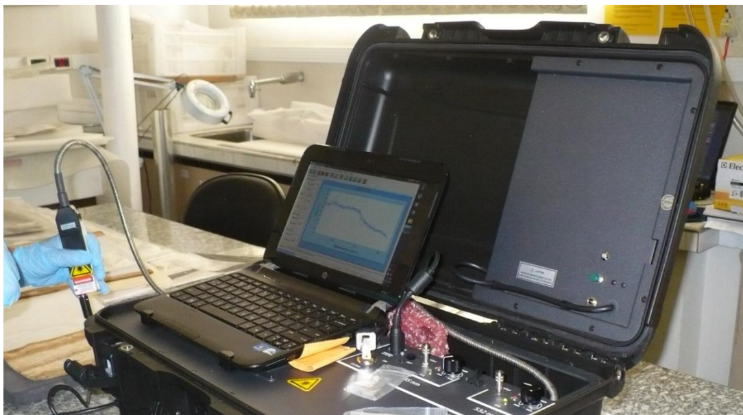
Figura 7.7 - Equipamento Raman utilizado nas medidas dos espectros Raman de; tecidos arqueológicos da coleção do MAE-USP, fibras da cultura Puky da Bolívia e fibras naturais de vicuña.
