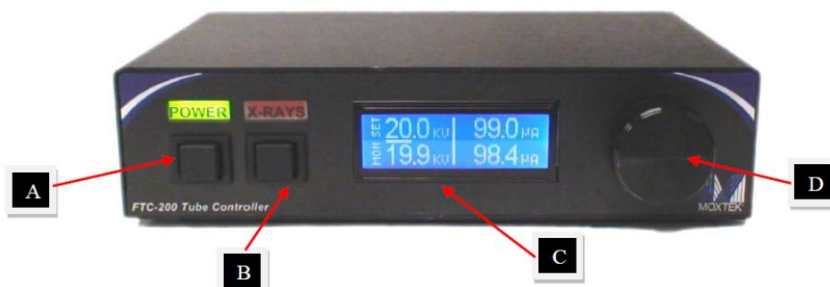
Figura 5.6 - Modelo FTC 200 de alta tensão utilizada tanto nas medidas in situ quanto nas medidas nos laboratórios. Fonte Moxtec Inc. 2016.
