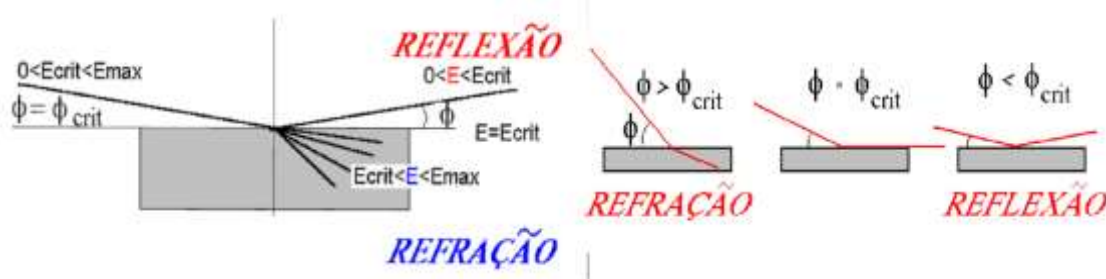
Figura 8 - Diagrama representativo da refração e reflexão de um feixe de radiação monoenergético em função do ângulo crítico de incidência.
