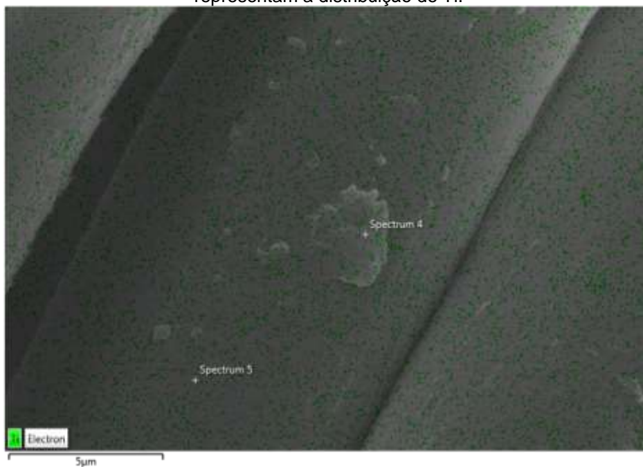
Figura 32 - Imagem com magnificação de 10.000x obtida por MEV da amostra 1. Os pontos verdes representam a distribuição de Ti.
